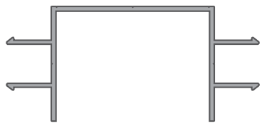
4104 Kenar Profili Edge Profile 0,642 kg/m
